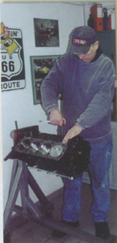
Montage der Roller- Hydrostößel- Halterung.
