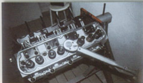
Die Köpfe werden in drei bis vier Schritten angezogen. Wir haben einen Drehmomentschlüssel mit Ft.- Lbs.- Einteilung. Dadurch entfällt das lästige Umrechnen auf N-Motor.
