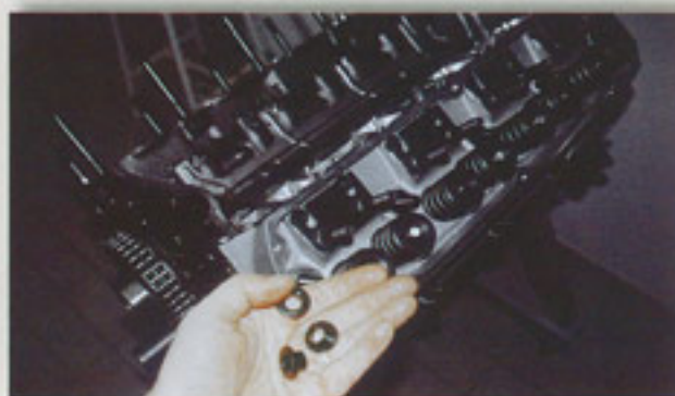
Die Köpfe sitzen. Jetzt müssen die Adapterscheiben eingesetzt werden und dann kommen die Muttern drauf. Beide unbedingt mit dem Spezial-Fett einschmieren!
