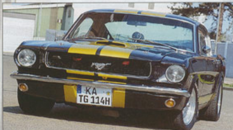
Ready to rumble - sattes Standing durch 50 Millimeter Tieferlegung und breite Spur der 9-Zoll-Hinterachse
