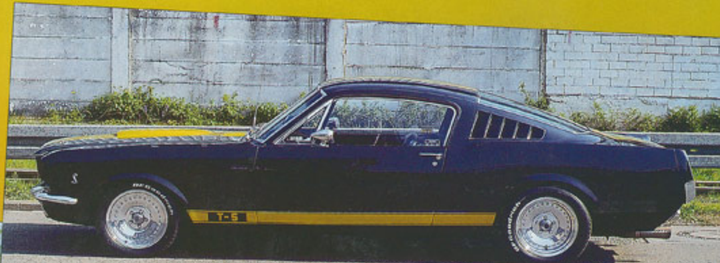
Fastback 66. Im Gegensatz zum 67er Modell hatte die Dachlinie einen Knick und verlief nicht durchgängig bis zum Heck
